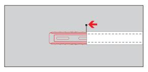
Den Verbinder – mit der geschlossenen Verbinder-U-Seite zum Scheibenzwischenraum – bis zur zweiten Kieme in den Profilstab schieben.
